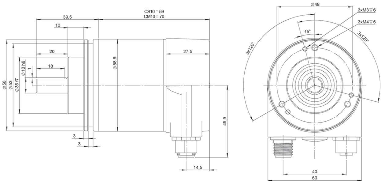
示例图纸对应选项为 轴型 2, 出线类型 2, 夹紧法兰 (法兰 1)
