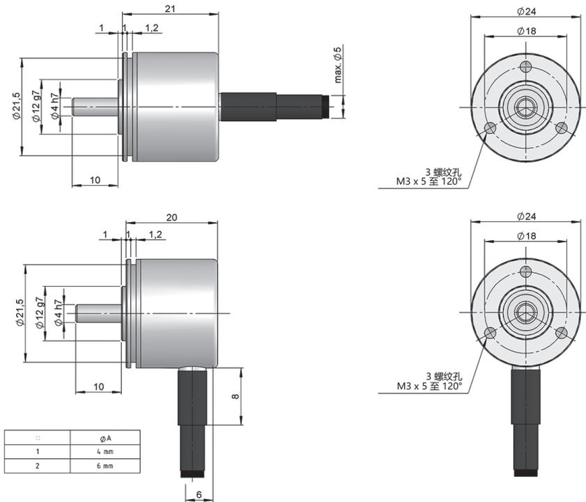
示例图纸对应选项为 轴型 1, 出线类型 1/2
