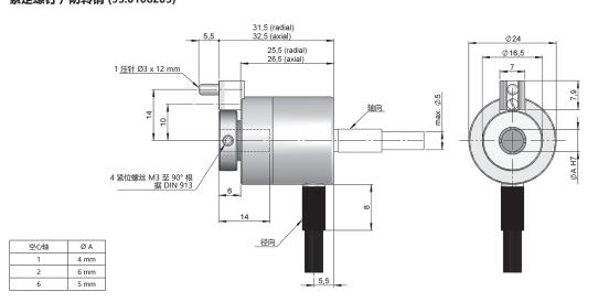
示例图纸对应选项为 盲孔空心轴 机械选项类型 2 (防转销 93.0108204, 包括压针), 出线类型 1/2
