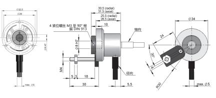
示例图纸对应选项为 盲孔空心轴 机械选项类型 4, 出线类型 1/2
