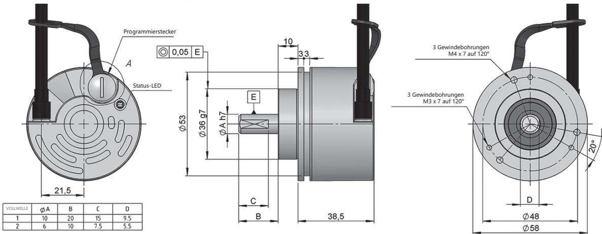
Maßzeichnung Vollwelle Typ 1, Anschluss 1, ohne Flansch
