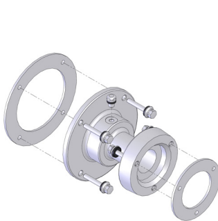
罩形联轴器 90.1610 卫生设计符合 EHEDG 标准>.
