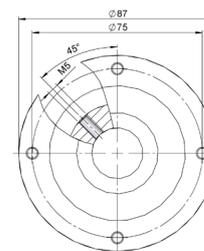
Kit de montage inclus: Joint plat D8 (1u) Cap M5 (1u), Joint plat Ø87 (1u), Joint plat Ø58 (1u), Rondelle d'étanchéité M4 EHEDG (7u), Vis EHEDG (7u).
