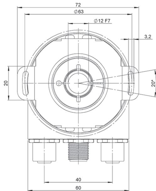
Maßzeichnung Vollwelle Typ 4, Anschlüsse 2 (Radial)
