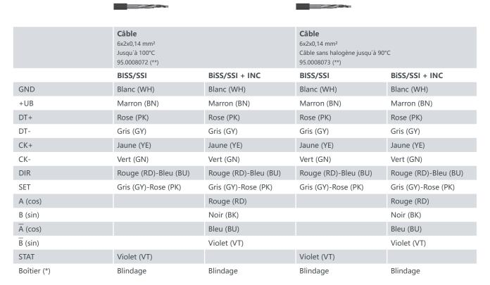
(\*) Blindage connecté au boîtier du codeur. Il est recommandé de connecter l'extrémité du blindage à la terre de l'équipement où le codeur est connecté. 😓
